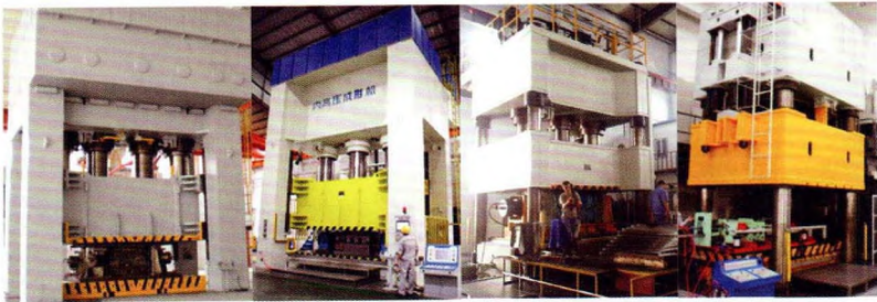
图4 哈工大研制内高压成形机
