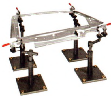
图3 ZEISS的模块化夹具系统
