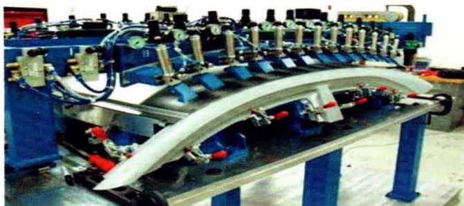
图3 激光钎焊顶盖夹具
