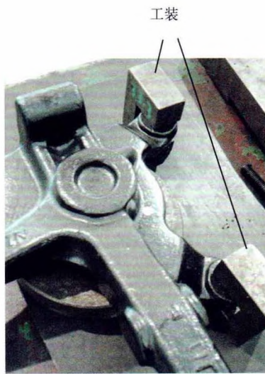
图5 定量型的防错工装
