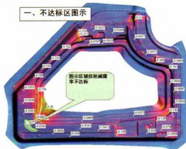
图2 拉延变薄率CAE分析
