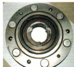
图2 半轴断裂图片
