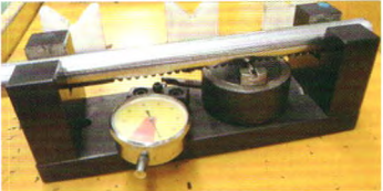
(c) 齿条齿倾角测量过程
