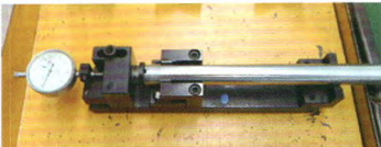
(d) 齿条齿部起点测量过程 图6 专用测具现场应用
