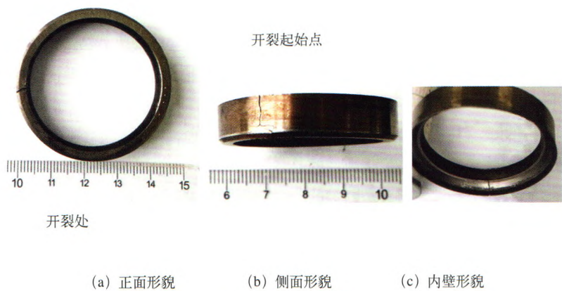
图1 气门座圈宏观形貌
