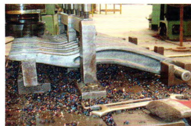
图4 汽车扭杆力臂尾部平面铣削新型组合夹具加工
