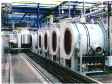
图3 德国ALD公司低压真空渗碳高压气淬生产线
