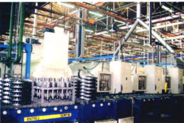
图4 法国ECM的ICBP型连续式低压真空渗碳自动生产线
