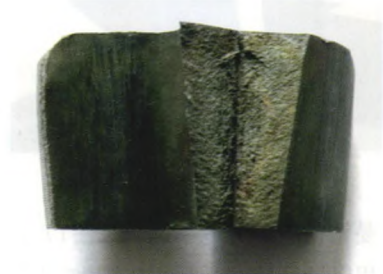
图3 齿轮轴断口形貌
