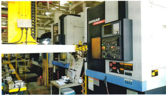
图3 工作中的PUMA V405立式数控车床
