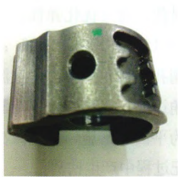
图23 弹性销孔与倒角尖角过渡
