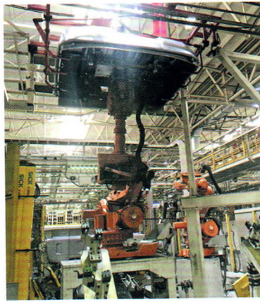
图8 顶盖线取消翻转机构及新增搬运机器人搬运装置
