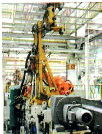
图8 顶盖线取消翻转机构及新增搬运机器人搬运装置
