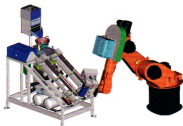
图4 高速射钉铆设备构成
