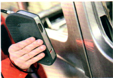
图4 激光测量间隙平顺度
