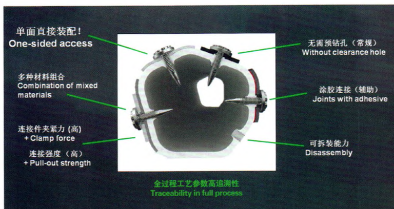
热融紧固连接装配工艺的相对技术优势
