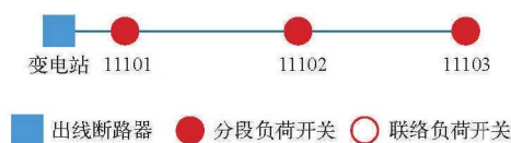
图3 单电源辐射型配电线路
