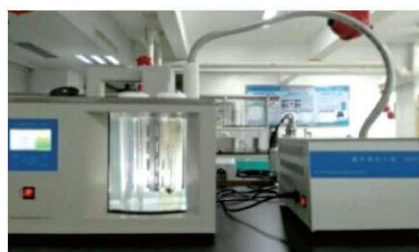
图3 密度计滴定法测定变压器油密度实物图
