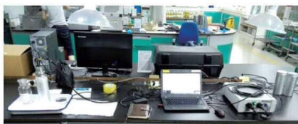
图2 多频超声波检测变压器油密度装置实物图
