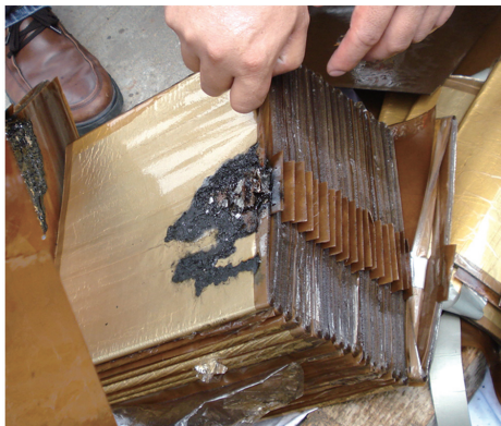
图3 分压电容部分电容屏击穿
