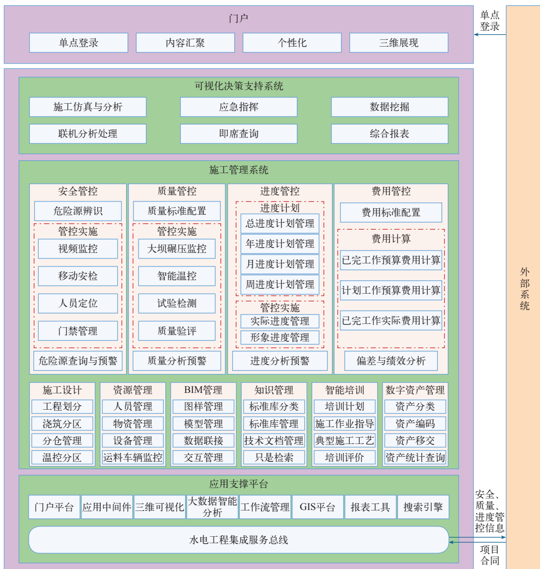
图1 应用支撑架构方案
