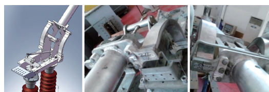
(d) 铝型材和软连接的连接处 (铝-铝) (e) 下部导电管和软连接的连接面 (铝-铝) (f) 下部导电管和中间软连接的接触面 (铝-铝)
