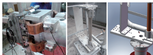
(j) 动触头处软连接部位 (铜-铝) (k) 夹紧块和弯板的接触面 (铝-铝) (l) 弯板和接线板的接触面 (铝-铝)
