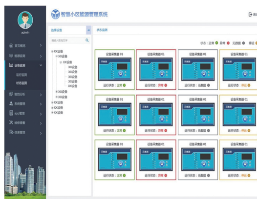
图10 智慧小区能源管理系统—设备监测页面图
