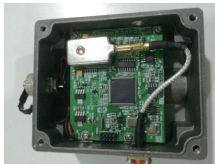
图4 传感器模块内部器件布置
