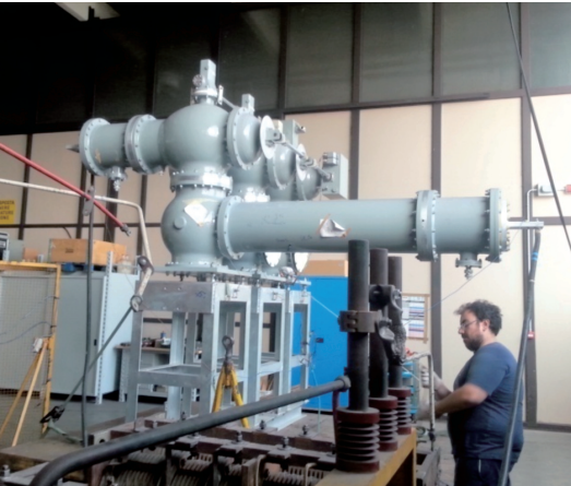
图3 隔离开关型式试验照片
