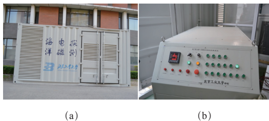
(a) (b) 图5 大功率海洋电磁发射机试验设备
