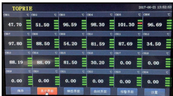
图5 380 V/80 kW模块式APF各监测点温度
