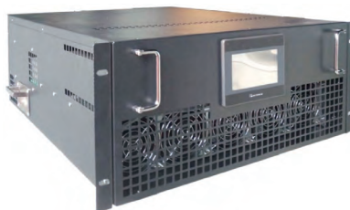
图4 380 V/80 kW模块式APF实物试验平台
