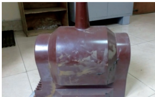
图1 外壳出现迸裂的电压互感器
