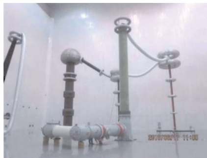
图4 1 100 kV \text{SF}_6/\text{N}_2 GIL绝缘试验样机布置
