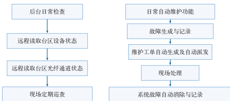
图4 塑料光纤用电采集系统自主运维流程
