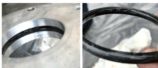
图5 O形密封圈破损情况
