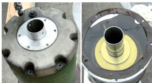
图4 油枕盖板与胶纸密封垫
