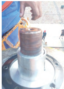
图3 引线穿心螺杆发热变黑
