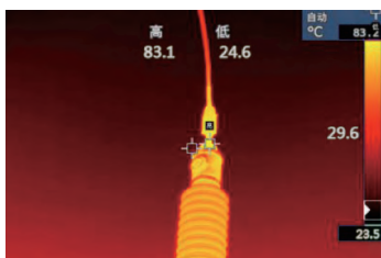
图4 110 kV B相套管头发热
