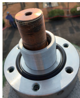
图5 引线穿心螺杆受热发黑
