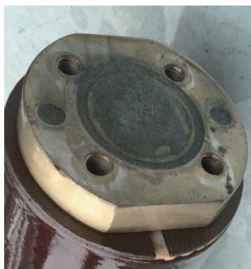
图8 套管底部接触面发热痕迹
