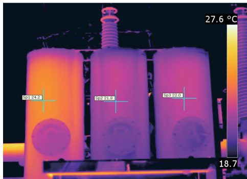
图1 286断路器红外图谱
