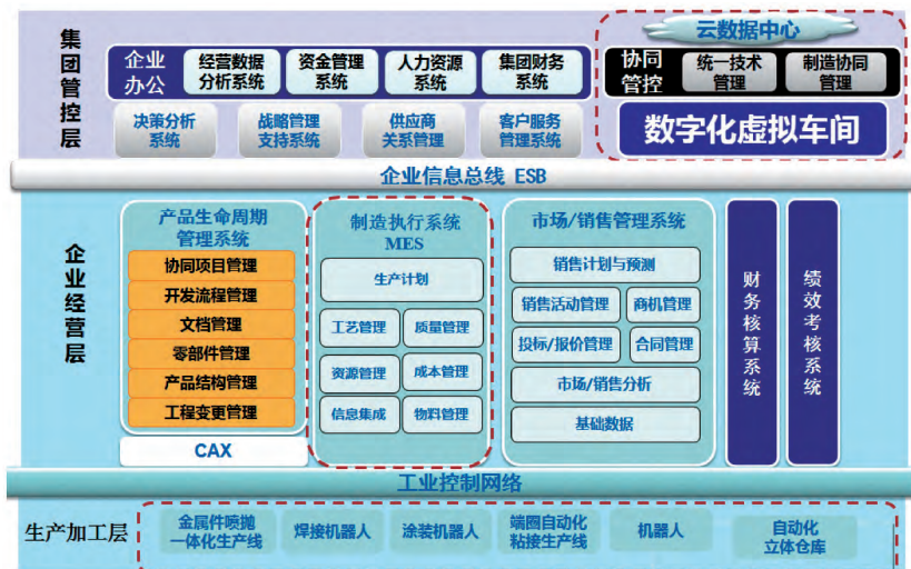
图2 高端变压器智能制造数字化车间体系架构
