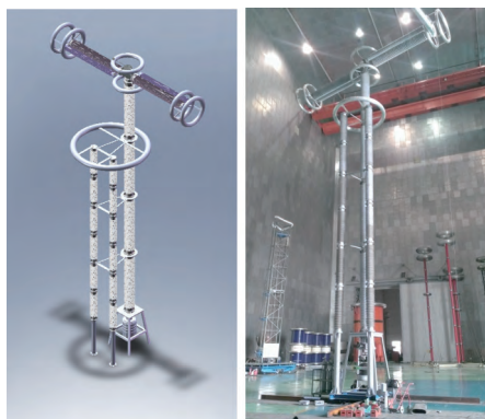
图5 ZPLW1-1120直流旁路开关
