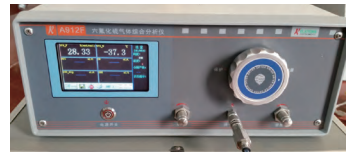
图4 混合气体比例测量试验
