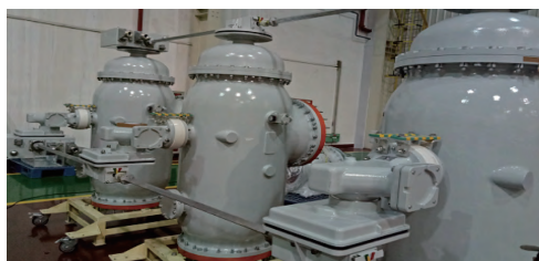
图4 分合闸机械指示的试验样机
