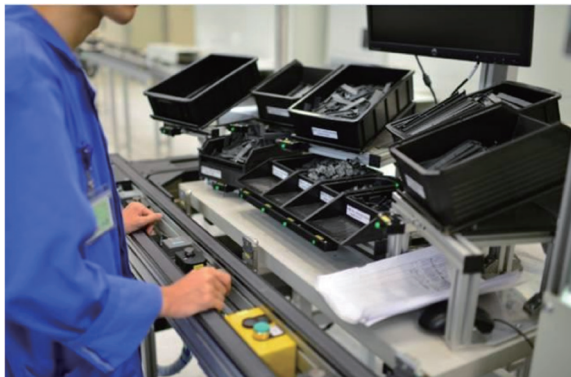
西门子成都工厂的自动防呆系统，零件盒的指示灯能够提示工人按需安装
