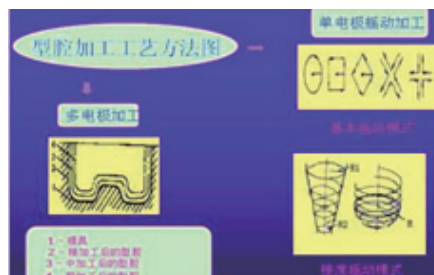
图 1 电极摇动方式简图
