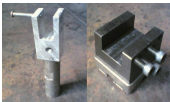
图 11 简易 U 型夹板与 3R 底座夹板
