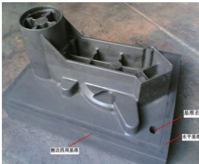
图9 电极正面基准的做法
