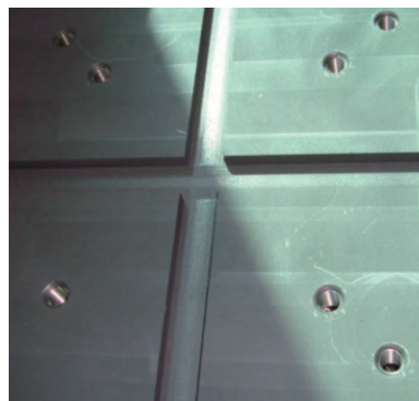
图 13 200mm 以上的石墨电极的背面加工
