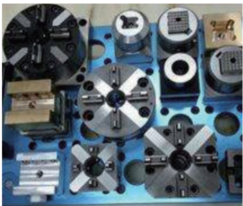
图 14 3R 夹具系统图例
