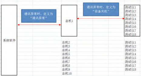
图 11 设备联网数字化原理图
