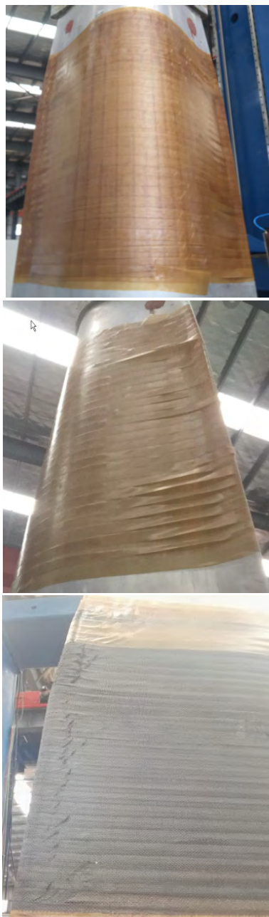
图 11 自动铺缠改进前试验效果
