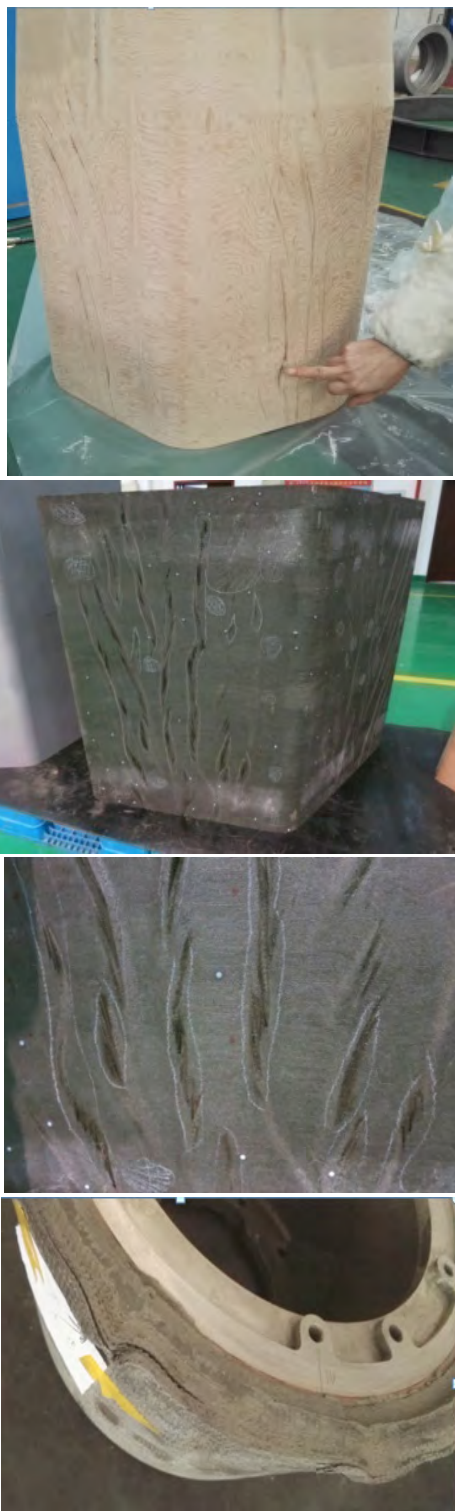
图1 传统铺缠装备产品缺陷示意图
