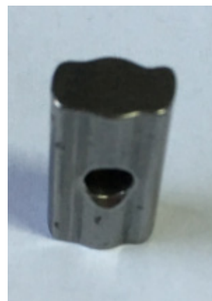
图7 斜撑块最终成品图
