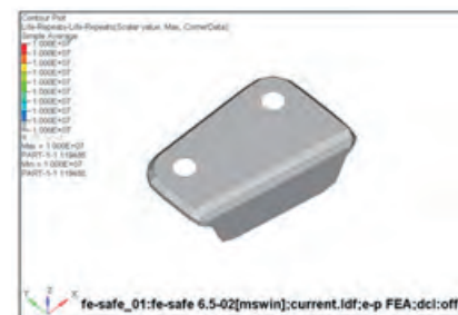
图 7 撑杆安装加强板(4)应力应变云图
