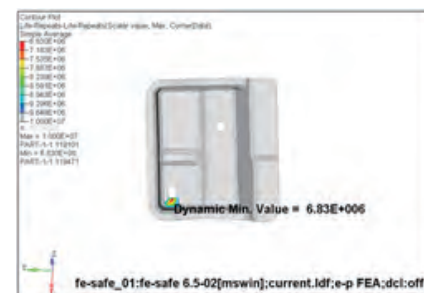
图 6 撑杆安装螺母板(3)应力应变云图
