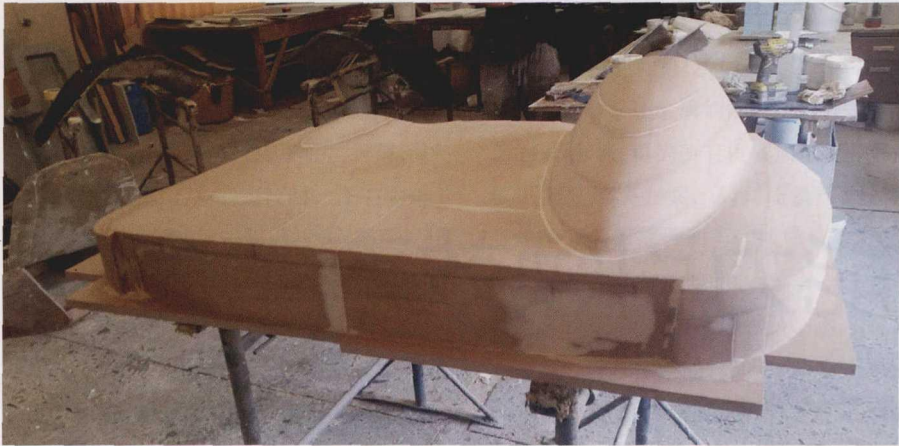
图 3 16 块模型板必须精确地装配在一起，这样才可确保最后的玻璃纤维顶盖形状符合要求，所需要的手工修整打磨的工作量也能达到最小
