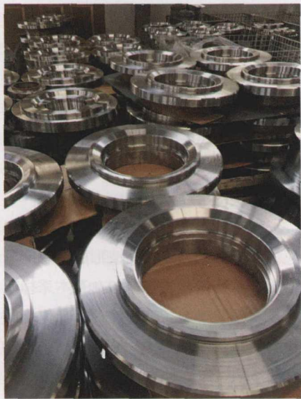
图 2 赛克思工厂中使用瓦尔特车刀刀具生产出来的减速机机壳
