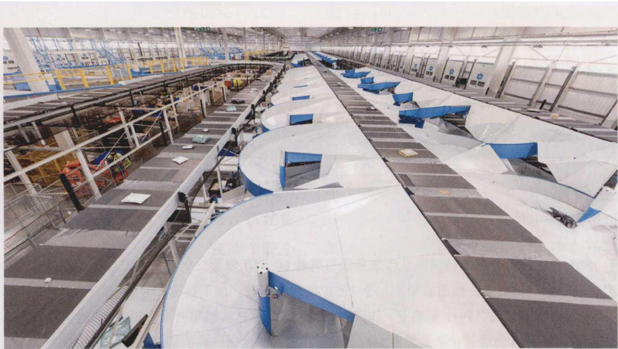
图 2 Beumer 集团公司为 Hermes 公司新建物流中心配备了高性能的分拣技术和分装技术设备
