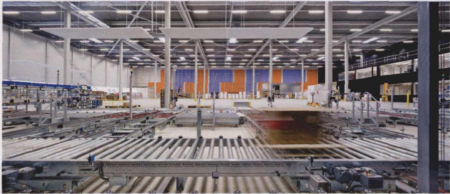
图 5 KingDrive, 柔性的、可增减的、输送重量 50 kg 以内的容器和包装箱的物流输送系统
