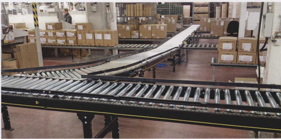
图 3 DAMA Spa 公司新建的物流中心配置了长度大约 100 m 的 Interroll 模块化输送平台
