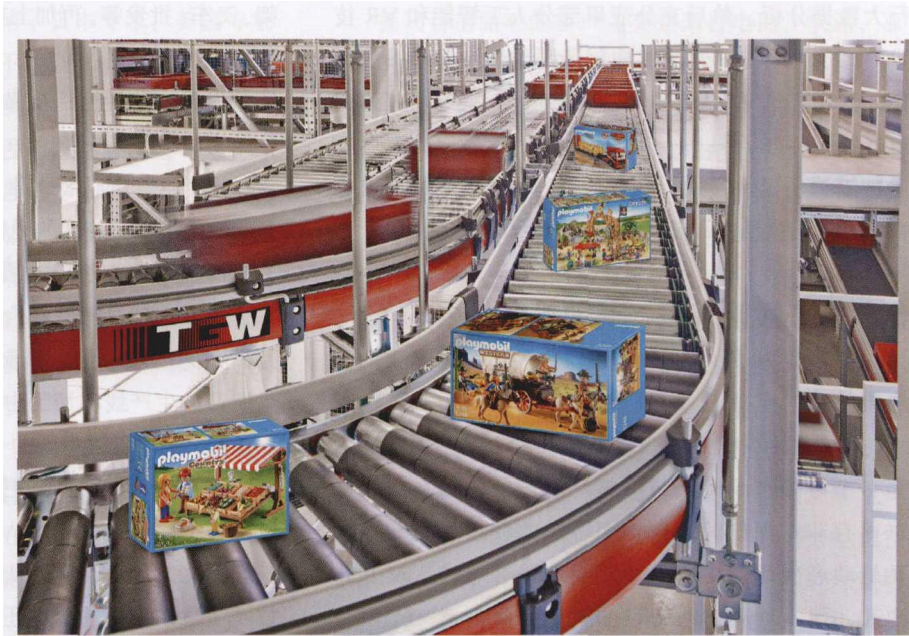
图 1 Playmobil 公司新企业内部物流中心采用了全新的高效物流输送技术 KingDrive
