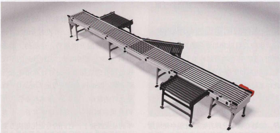
图 4 Gebhardt 公司的 F-Red 分拣设备是一种模块化的升降式分拣机;可以通过多种多样的配置方式集成到现有物流设备系统中去
