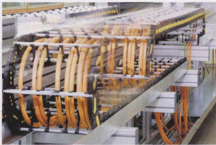
图 6 聚氨酯上高动态性能应用电缆的首选保护材料，例如 Lapp 公司研发生产的 Ifelx Servo FD 7DSL 电缆
