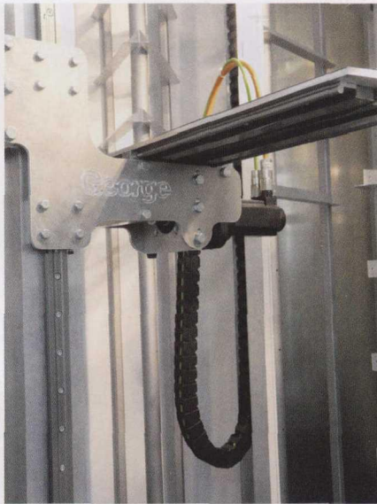
图 7 Drylin T 线性轴承保证了承载装置导轨的精度；其电缆拖链的设计非常紧凑
