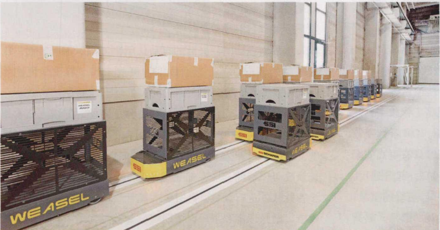
图 1 从地点 A 到地点 B 的自动化：例如在纺织品运输中使用的 Weasel 运输车
