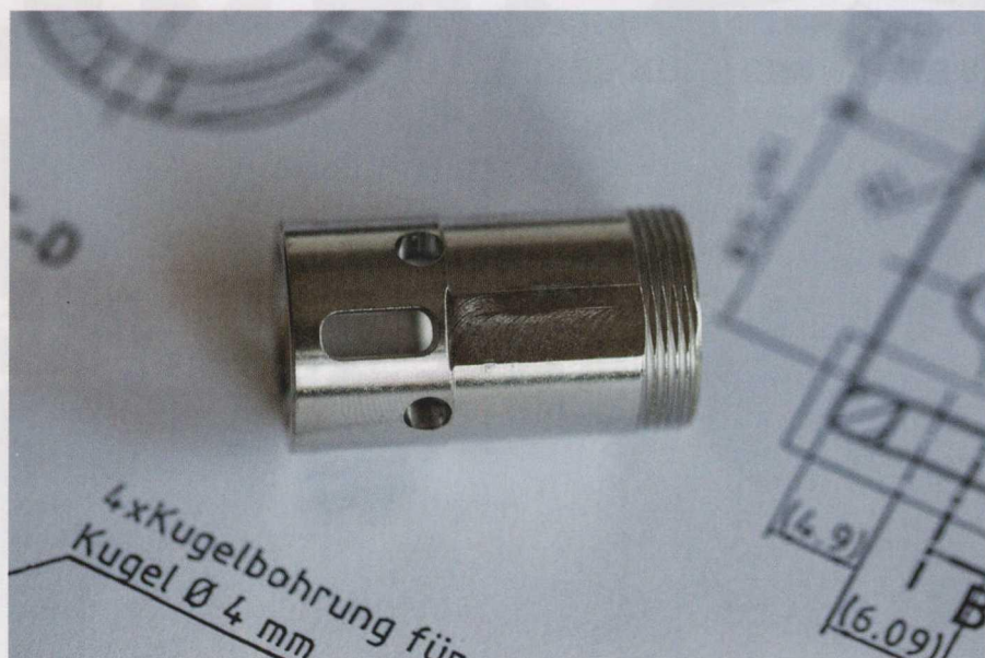
图 2 快速封闭耦合部件可以阻止在松解时的爆裂现象。其制造过程非常复杂，采用 Blum 公司的 TC76-Digilog 型测量探头，可对 4 个略呈锥形的长孔进行测量
